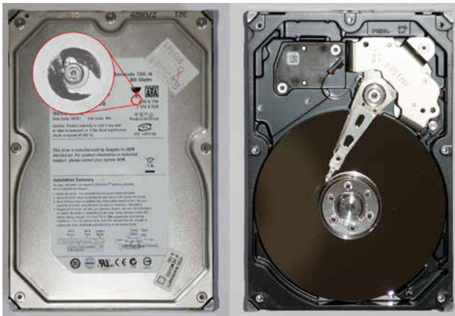
Die versteckte Schraube unter dem Hersteller-Label und das Innenleben einer Festplatte
